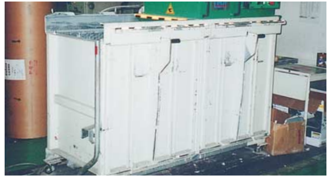
紙類の圧縮回収装置(本社工場)
