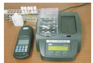
広島工場に設置した窒素リン簡易測定装置
